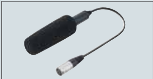
AG-MC200MC XLR型话筒 灵敏度: -40 ±3.5dB (0dB=1V/Pa, 1KHz) 最大输入电平: 127dB (1000Hz, 失真小于1%) S/N: 大于 69 dB
