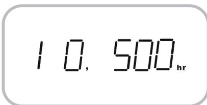
第一组耗材剩余使用时间页面。按下移键进入第二组耗材剩余使用时间页面，按上移键返回运行时间显示页面，按返回键返回主页面。（下图所示剩余500小时）
