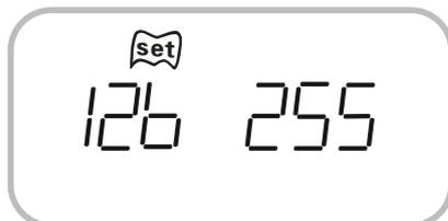
**报警功能：**此参数确定部分报警功能的使用和取消，每位设0功能有效，设1报警功能无效。（详见参数表）注意：此参数与硬件有关请勿随意设置以免带来意想不到的情况。
