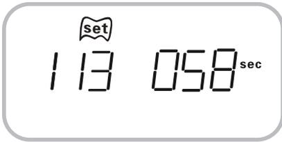
在显示状态下，按下移键进入第十三个参数（制氮机吸附时间2）设置页面，按上移键返回第十一个参数（吸干周期时间）设置页面，按返回键返回主页面。
