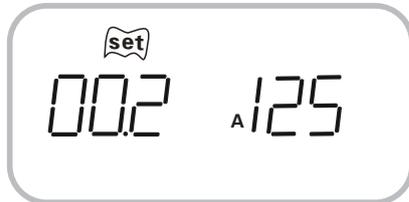
**风流电机：**此参数确定风机额定电流以便对风机进行过载保护（需要控制器硬件支持）。
