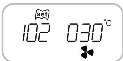
在显示状态下，按下移键进入第二个参数（风机停止温度）设置页面，按返回键返回主页面。
