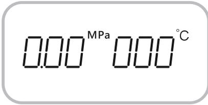
主页面屏幕左侧为排气压力(MPa)，右侧为吸气温度(°C)。在数据行的上下两侧各有一些图标指示空压机的工作状态与报警信息。
