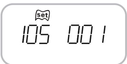
在显示状态下，按下移键进入第五个参数（机组号）设置页面，按上移键返回第三个参数（上限压力）设置页面，按返回键返回主页面。
