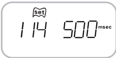
在显示状态下，按下移键进入第十四个参数（制氮机吸附时间3）设置页面，按上移键返回第十二个参数（制氮机吸附时间1）设置页面，按返回键返回主页面。
