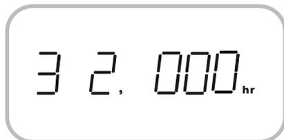
第三组耗材剩余使用时间页面。按下移键进入电机电流显示页面，按上移键返回第二组耗材剩余使用时间页面，按返回键返回主页面。
