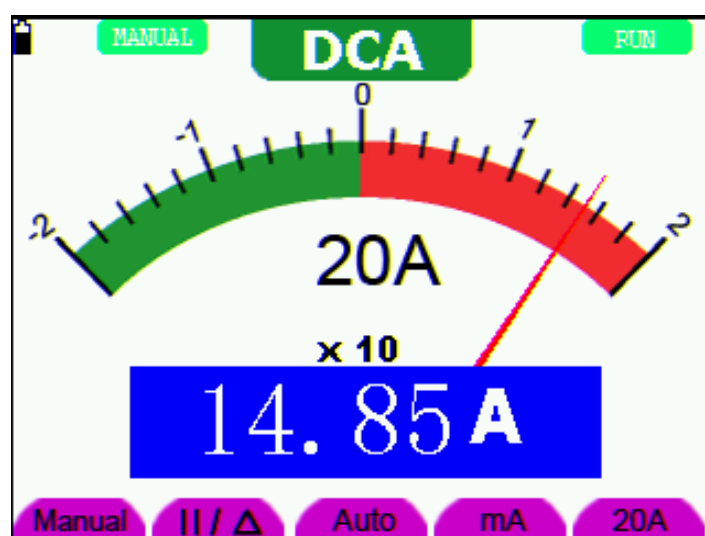
图 25: 直流电流20A量程测量界面
