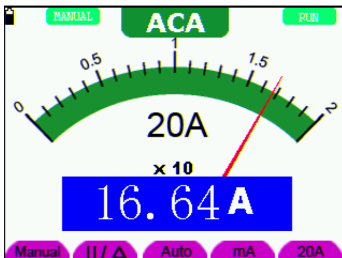
图 27: 交流电流20A测量界面
