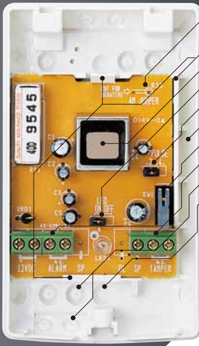
报警记忆跳针(FX-40L/DL) 电路板保护墙 探头 LED开关（开/关） 脉冲计数（2或4） 走线槽 防拆开关 端口 接线脱模孔 安装脱模孔
