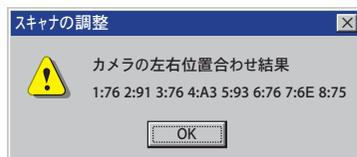
エラーメッセージが表示された場合は、原稿を取り出してガラスを拭き、原稿押さえを確実に取り付けてから再起動しテストをやり直してください。
