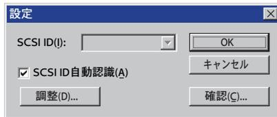
SCSI ID 自動認識 ..... システムに接続しているスキャナのSCSI ID 番号を自動的に認識し、設定します。2台以上接続されている場合は、若いID 番号が優先的に接続されます。
