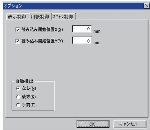
読み込み開始位置 ..... 読み込み開始位置をずらし、先端の余白などを読み飛ばすことができます。
