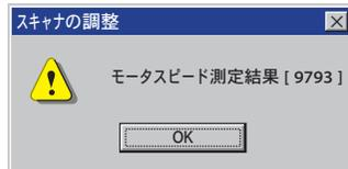
エラーメッセージが表示された場合は、原稿を取り出してガラスを拭き、原稿押さえを確実に取り付けてから再起動します。再度、モータスピードテスト(ステップ⑩から)をやり直してください。
