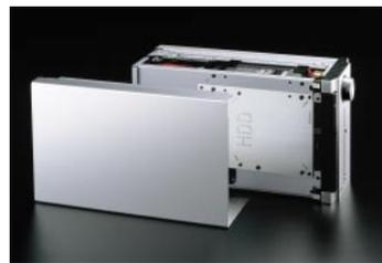
そして内部レイアウトにもオーディオノウハウを惜しみなく投入しています。オーディオ回路とPC回路の電源部そのものも分離して、ケース内に二つのコンポーネントが実装されているような配慮を徹底しています。この他にもデジタル入出力部にプロオーディオ仕様のパルストランスを搭載、PC部とアンプ部をつなぐデジタルコントロールボードの新開発などアンブ一体型コンピュータの品質を究極に高める仕様を徹底しました。
