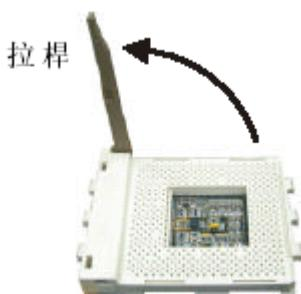
5. 将CPU上的金色三角标记（表示接脚一）与主板上处理器插座的第一接脚位置对齐。
