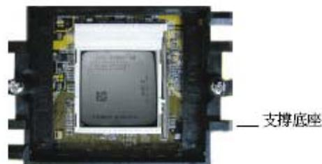
3. 將散熱片置於 CPU 上方，將彈夾的其中一邊勾入支撐底座；彈夾上的孔位須與底座上的勾榫卡緊。
