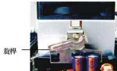
5. 將旋桿推至鎖定位置，風扇與散熱片即可牢固地安裝在支撐底座上。
