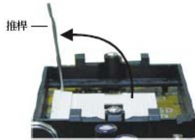
5. 從腳座上方將 CPU 垂直置入；CPU 上的金色標記須對準 CPU 腳座的一角；請參考下圖。
