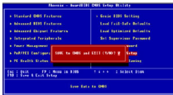
請鍵入 <Y> 後按 <Enter>。所有更改過的設定值會存入CMOS 記憶體中，同時系統將會重新啓動，再次回到開機自我測試畫面。此刻若想再次更改某些設定，可於記憶體測試及計數完畢後，按 <Del> 鍵進入 BIOS 的設定畫面。
