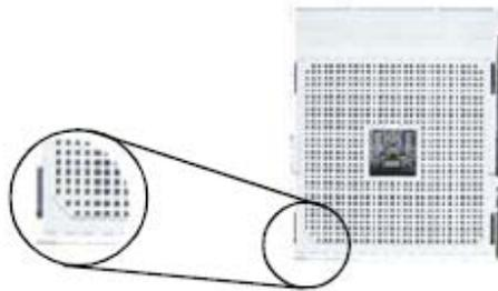
6. 將 CPU 完全置入腳座。置入的方向正確才可順利安裝；因此，若發現 CPU 無法順利置入腳座時，切勿強行施力。
