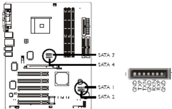
本主機板配置了四個 SATA 接頭： J11 (SATA 3), J10(SATA 4), J21 (SATA 1) 與 J20 (SATA 2)，可連接 SATA裝置。安裝時，請將 Serial ATA 排線一端的接頭接至這些接頭上，並將另一端的接頭接至你的 Serial ATA 裝置上。
