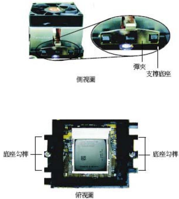
4. 將彈夾的另一邊 (靠近旋桿的一邊) 卡入支撐底座；同樣地，其上的孔位亦須與底座上的勾榫卡緊。
