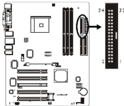
本主機板提供一個軟碟機接頭，可連接兩台標準軟碟機。此接頭有預防不當安裝的設計，安裝時必需將排線一端 34-pin 接頭的第一腳與主機板上軟碟機接頭的第一腳對應妥適，才能夠順利安裝。
