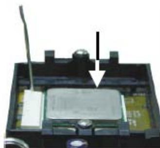
7. CPU 置入後，將推桿推下，卡進腳座側邊的卡榫，以確保CPU 已牢固地安裝於腳座上。
