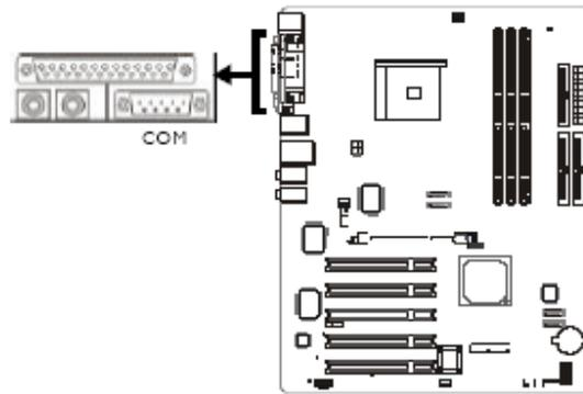
本主機板背板位置備有一個藍綠色串列埠 (COM)。此串列埠為相容於 16C550A UARTs 規格的非同步 RS-232C 通訊埠，可連接數據機、串列印表機、終端機及其它串列裝置。
