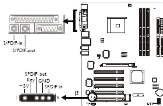
本主機板背板位置備有一個 S/PDIF-in RCA 插孔 (紅色) 及一個 S/PDIF-out RCA 插孔 (黃色)。另於主機板上有一個 S/PDIF 光纖接頭 (J3)，可外接 S/PDIF光纖傳輸線。安裝時，請將您的光纖傳輸線接頭接至主機板上的 S/PDIF 光纖接頭；請確定光纖傳輸線接頭的第一腳與主機板上 J3 接頭的第一腳已對應妥適再行連接。RCA S/PDIF 音源插孔與 S/PDIF 光纖接頭 “請勿” 同時使用。
