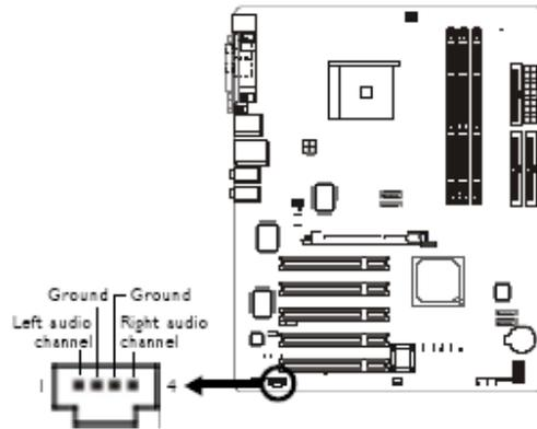
經由 CD-in (J4) 音源輸入接頭可接收來自光碟機、電視諧調器或 MPEG 卡的語音訊號。
