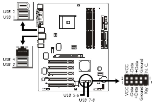
本主機板的背板位置備有四個黑色的 USB 2.0/1.1 埠 (USB1/2/3/4)。透過 USB 埠，系統可同時與數個隨插即用的週邊設備進行資料交換。主機板上另有兩個 USB 接頭：J17 (USB 5/6) 與 J18 (USB 7/8) 接頭，可再接出四個額外的 USB 2.0/1.1 埠。安裝時，請將你的 USB 埠檔板模組上接線接頭的第一腳與 J17 或 J18 接頭的第一腳對應妥適再行連接，並裝檔板架於機殼上。
