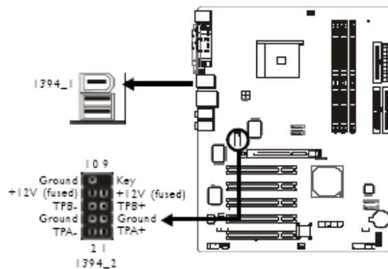
本主機板的背板位置備有一個 IEEE 1394 埠 (1394\_1)，另於主機板上有一個 IEEE 1394 接頭 (1394\_2 - J8)，可接出一個額外的 IEEE 1394 外接埠。安裝時，請將你的 IEEE1394 檔板模組上接線接頭的第一腳與主機板上 J8 接頭的第一腳對應妥適後再行連接，並將檔板架於機殼上。
