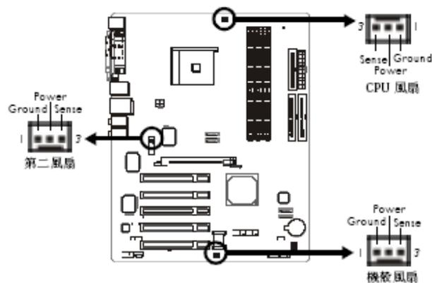
為預防 CPU 溫度過高，請務必安裝 CPU 風扇與散熱片。安裝 CPU 風扇時，請將風扇接線接至主機板的 J16 接頭。第二風扇接頭 (J6) 與機殼風扇接頭 (J15) 可用來連接系統中的散熱風扇。散熱風扇可保持機殼內適當的空氣流通，防止 CPU 及系統元件因過熱而受損。
