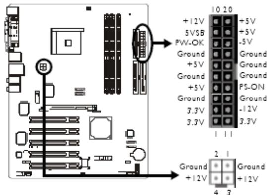
我們建議您使用與 ATX 12V Power Supply Design Guide Version 1.1 設計規格相符的電源供應器；此類電源供應器有一個標準的 20-pin ATX 主要電源插頭及一個 4-pin +12V 的電源插頭，需分別插在主機板上的 J24 和 CN9 接頭上。4-pin +12V 的電源接頭可供應大於的電壓調節模組（Voltage regulator Module, VRM）。本主機板至少須使用 250W 的電源供應器。如果系統的負載較大時（較多記憶體模組、介面卡及週邊裝置等），可能需要更大的電源供應；因此，使用 300W 或以上的電源供給器才可確保足夠的供電。
