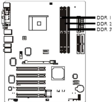
本主機板支援 DDR SDRAM DIMM。DDR SDRAM(Double Data Rate Synchronous Dynamic Random AccessMemory) 為 SDRAM 記憶體的一種，它在每一時脈的上升緣及下降緣都會進行資料的讀寫，以達成雙倍的速率，使資料傳輸更具效率。有關本主機板所支援的記憶體規格，請參考第一章的系統記憶體相關說明。
