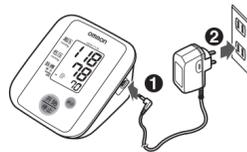
若要断开电源适配器连接，请先从电源插座上拔下电源适配器的插头，然后立即从本体上拔下电源适配器的插头。如需购买另售的电源适配器，请拨打客户服务热线咨询。
