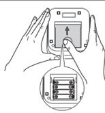
4. 重新关上电池盖。如图所示滑动电池盖, 直到听到“喀嗒”一声, 表明电池盖已关上。
