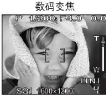
变焦指示的白色区表示光学变焦。如果 [数码变焦] 设为 [开]，变焦指示上将显示红色区。到达光学变焦的最大值时，数码变焦启用。
