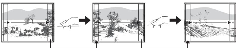
前一张图像中连接到后一张图像的部分，不会留在画面边缘的边框上。您必须记住边框上该部分是什么样子，然后再拍摄下一张图像，使其重叠。如果从左到右连接图像，在构图时，请将前一张图像的右侧与后一张图像的左侧重叠（如果从右到左连接图像，则以相反的方式进行）。
