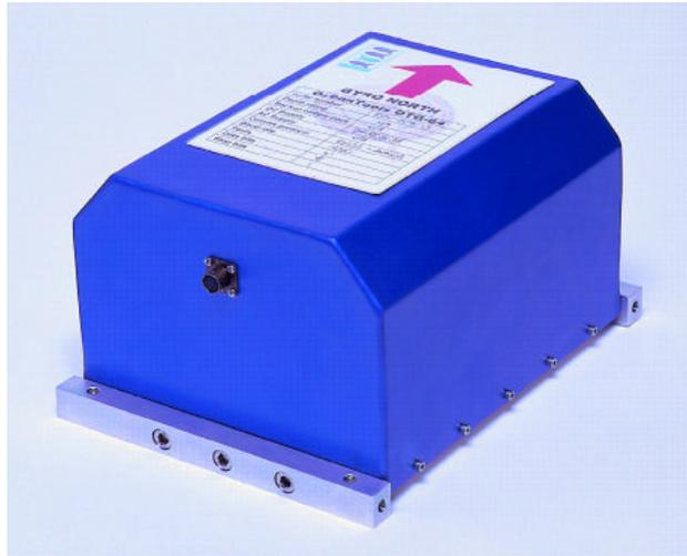
ROV-FOG 是一个高级，精确，全固态的真北光纤探测罗经和姿态参考单元，为直接与客户的 ROV 和 AUV 系统组合而设计。ROV-FOG 它不受外界磁场或铁的影响，适用于如管道，平台或其它金属作业的主系统。系统的可靠性强，无需保养维修。启动时间快，通常在 5 分钟内可输出超过 99% 精确度的航向。
