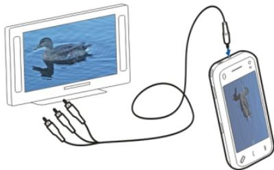
如果已将诺基亚视频数据线连接至设备，则设备中所有的音频(包括当前通话、视频片段的立体声音频、按键音和铃声)都将发送到电视中。设备的麦克风可以正常使用。
