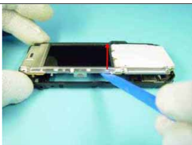
12.) 用 SS-93 撬起连有显示屏和 UI 屏蔽罩的 PWB 主板
