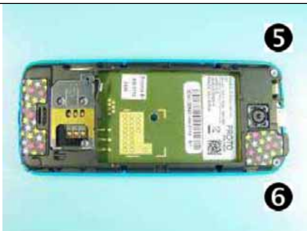
2.) 如图顺序使用 21Ncm ( ± 1Ncm) 的扭矩拧紧螺丝。
