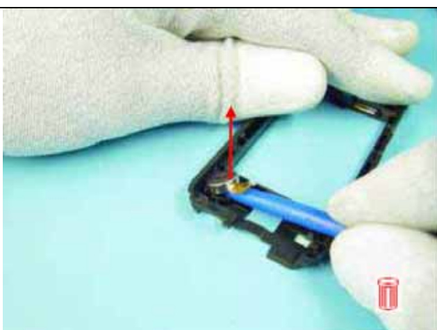
17.) 按图中所示方向使用 SS-93 取下振子，并且废弃
