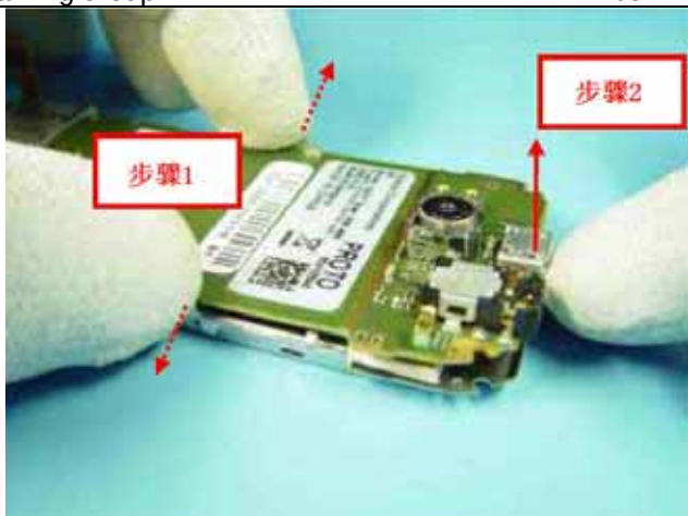
19.) 拆开 UI 组件上部分卡扣(步骤一), 分离 PWB 主板 (步骤二)
