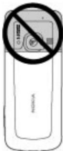
您的设备可能装有内置和外置天线。当天线发射或接收信号时，如非必要，请勿接触天线。接触天线会影响通信的质量，可能导致设备在电量级别较高的状态下工作，且可能缩短电池的寿命。
