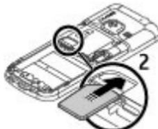
3 确保电池和手机的触点相互正对, 并装入电池。
