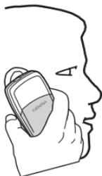
您的手机装有内置天线，它靠近手机的顶部。像持握其他电话一样持握本手机，使天线区域竖向上并应将手机置于耳侧。
