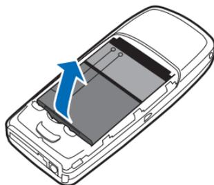
取下手机后盖后，将指尖插入指槽并从电池槽中掀起电池。
