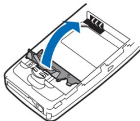
3. 将 UIM 卡插入卡夹内 (先插入切角一侧)，并使卡上的金色触点朝向手机并与手机的金色触点相对。
