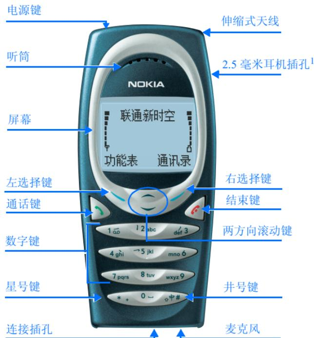
1. 此 2.5 毫米耳机插孔不支持诺基亚 2.5 毫米耳机。
