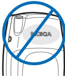
通话时，请将手机置于靠近耳朵的位置，同时应使指尖位于手机后盖的中部、天线区域的下方。
