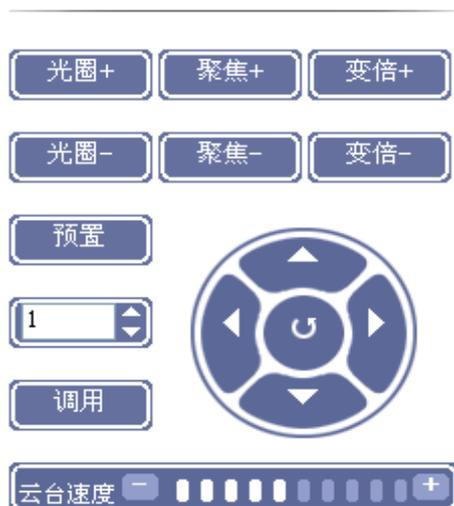
操作云台的向上/下/左/右方向按钮，球机能按照操作的方向转动；
