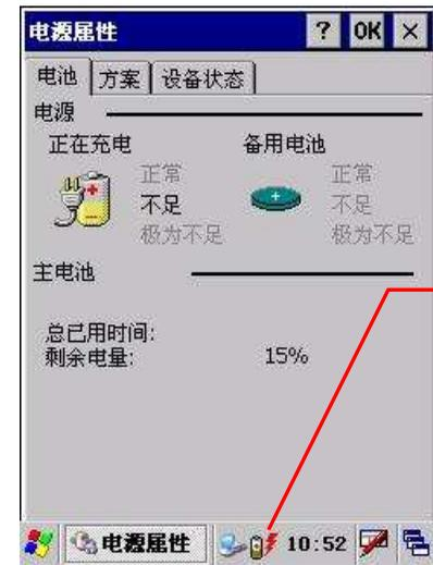
此图显示的是正在充电状态有一个红色雷电图号。
