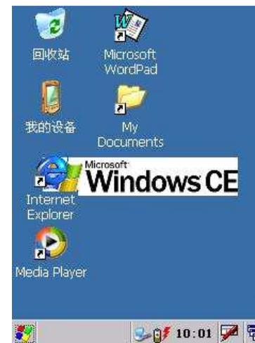
确认电源连接后, 把另一块正常工作的电池放入此设备中接上直充, 观察插上直充后任务栏显示。如果处于充电状态则会显示下图所示, 一个电池旁边带一个红色的雷符号, 并且扫描头上指示灯为红色。
