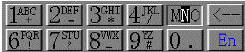
使用方向键选择要输入的字符，选中后字符为反白显示，按<确定>键输入字符，在输入消息框中出现输入的字符。如果要取消本字符的输入，按<取消>键即可。
