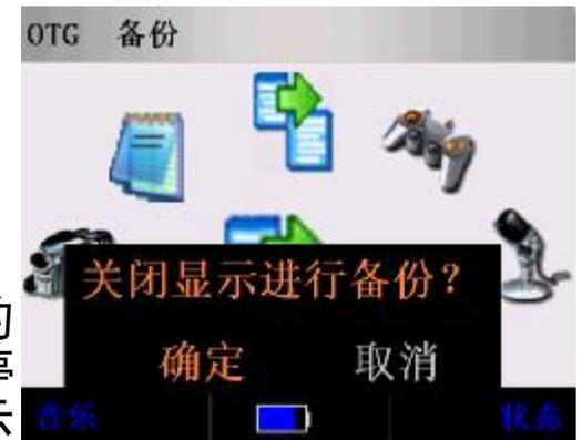
当操作完毕后，外部存储设备上的所有内容将被自动拷贝到播放机的C:\Backup\bak000X目录下，每次拷贝操作将新建一个目录，如bak0001, bak0002...等等。
