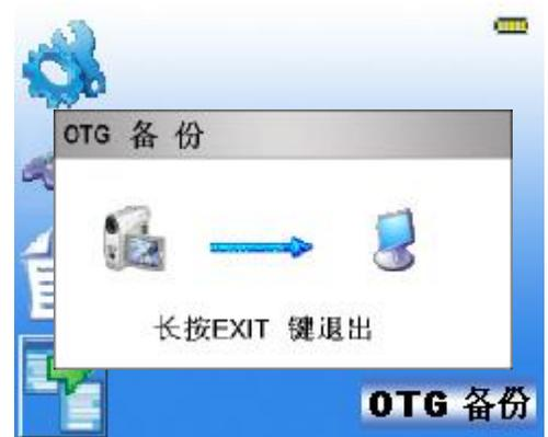
当操作完毕后，外部存储设备上的所有内容将被自动拷贝到播放机的C:\DSK0000x目录下，每次拷贝操作将新建一个目录，如DSK00001，DSK00002...等等。
