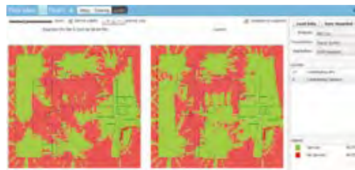
AirDefense LiveRF模块显示了针对特定应用——IP电话——的实时覆盖信息
