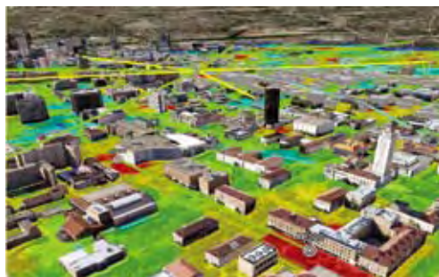
BroadbandPlanner可在基于谷歌地图的视图上显示复杂的网状网和点对多点网络覆盖预测
