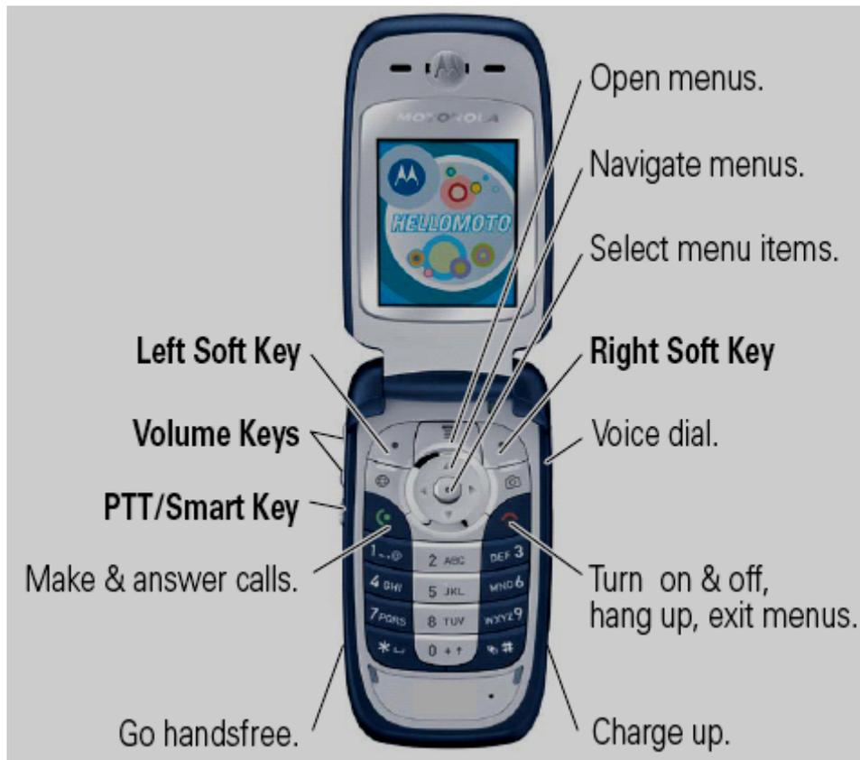
图1. 手机控制、指示器以及I/O
