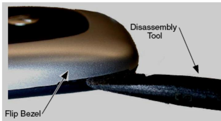
图13. 拆卸翻盖U型曲面
