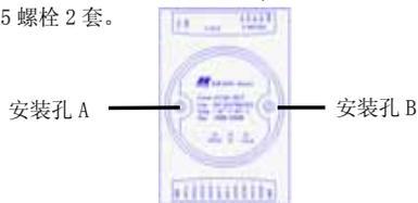
图 2-3 模块安装图示意图
