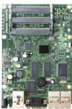
RB433支持Atheros AR7130 MIPS 24k 300MHz CPU，预装RouterOS L4级操作系统。可以用于中心AP骨干和多点覆盖应用，支持3个无线模块扩展，即能实现3个AP同时运行，降低运营成本。
