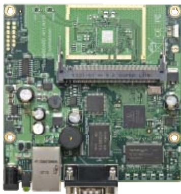
RB411采用Atheros MIPS 24k 300MHz CPU，1个100M以太网接口和1个MiniPCI扩展接口，集成802.11bg无线模块，可以用于点对点传输或WiFi覆盖，预装RouterOS L3级操作系统，用于CPE终端设备。
