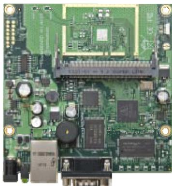
RB411AH采用Atheros MIPS 24k 680MHz CPU, 1个100M以太网接口和1个MiniPCI扩展接口, 集成802.11bg无线模块, 可以用于点对点传输或WiFi覆盖, 预装RouterOS L4级操作系统, 用于高带宽点对点和点对多点设备。
