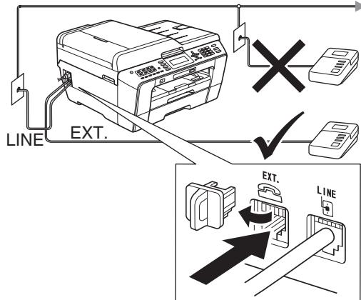
如果您有外接应答设备, 请将接收模式设置为外接应答设备。请参见第 8 页上的选择接收模式。更多详细信息, 请参见使用说明书 (基本功能) 第 6 章中的连接外接应答设备 (电话应答设备)。
