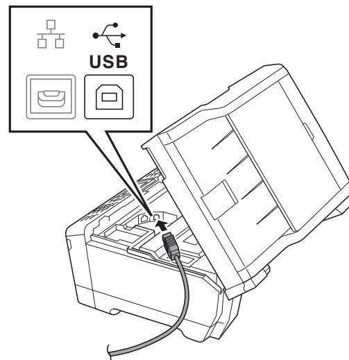
**c** 小心地将 USB 接口电缆嵌入电缆槽内并沿着凹槽绕到设备后部，然后将接口电缆连接到计算机。
