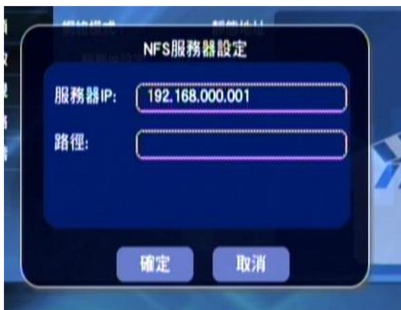
3) NFS 服務器設定，根據所連接的服務器設定而輸入服務器的 IP 位址 以及路徑。
