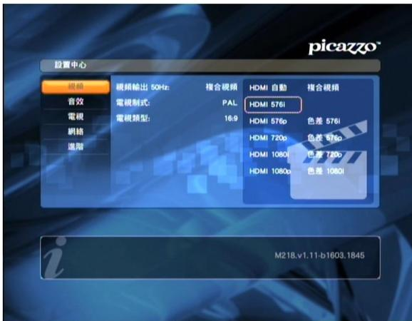
1. 視頻輸出 --- 提供視頻輸出訊號的制式以配合電視機的設定，包括支援 HDMI、色差及複合視頻。而 HDMI 更可採用自動，由系統選擇最佳模式。
