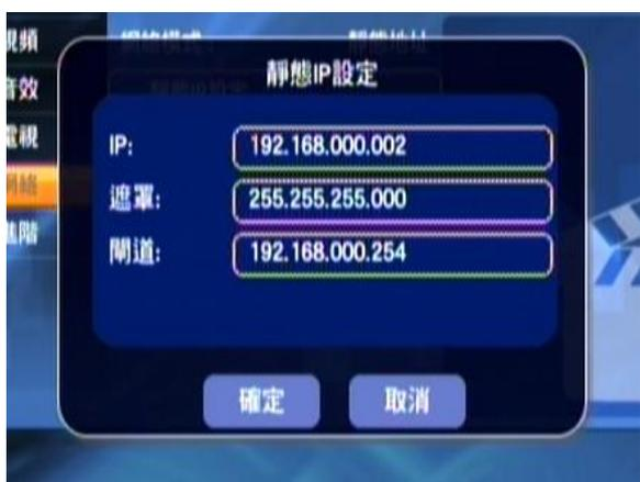
2) 動態地址是由路由器自動分配。而靜態地址需要根據所連接網絡設定而輸入有效設定的數值。(若頭一次使用或測試設定，建議首先採用動態地址)
