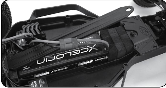
在您装入充满电的电池以后，重新安装电池压板。
