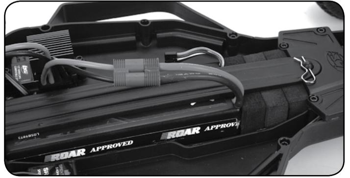
电池压板的一面是平整的，而另一面是带有加强筋的，带有加强筋的一面应当朝上。将电池以一定的角度插入电池支架内，然后将电池压板向下压，并用之前移走的车壳夹固定它。
