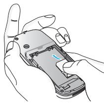
遵循以下步骤移除SIM卡。
