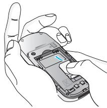
遵循以下步骤移除SIM卡。
