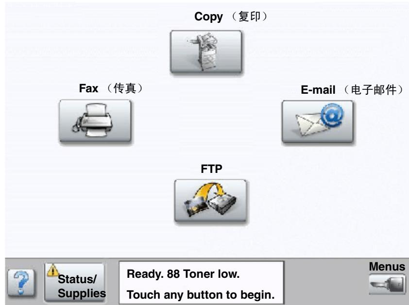
一旦需要消耗品部件或维护，MFP 控制面板上会发出警报提醒您。触摸屏底部的打印状态消息栏指出 MFP 是否处于 **Ready**（就绪）状态，并让您知道是否有消耗品不足或已空。触摸屏幕底部的 **Status / Supplies**（状态 / 消耗品），将打开 **Status / Supplies**（状态 / 消耗品）屏幕，您可以在这里查看各个进纸匣和其它消耗品部件的状态。
