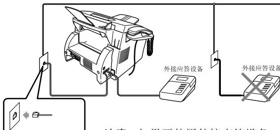
注意：如果要使用外接应答设备，应将接收模式设置为外接应答设备(第8步)。
