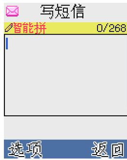
当用户按下拼音对应的**数字键**后就进入汉字输入状态，屏幕下方出现所按数字键可能对应的拼音组合和首个拼音的候选字，对于“好”，用户只需输入 426。
