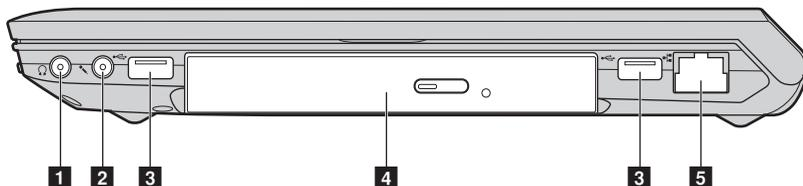
**1** 耳机插孔 连接外接耳机。
