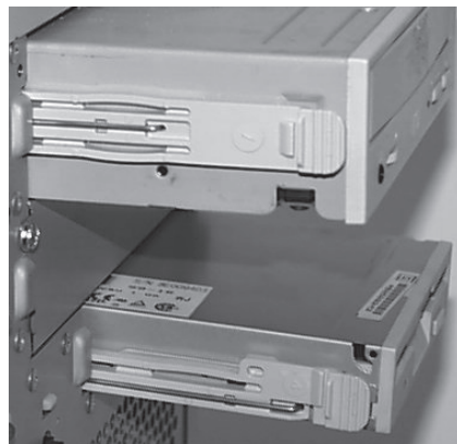
图 2-4 光驱、软驱安装图
