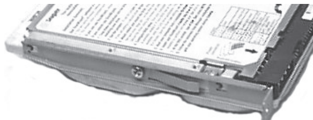
图 2-8 硬盘导轨安装图
