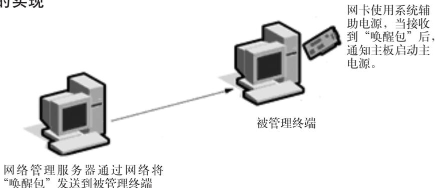
图1 网络唤醒工作原理示意图
