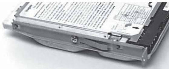
图 2-7 硬盘导轨安装图
