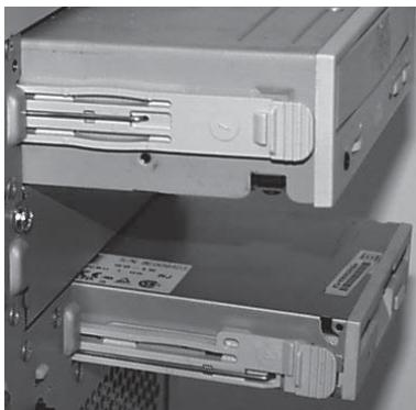
图 2-3 光驱、软驱安装图
