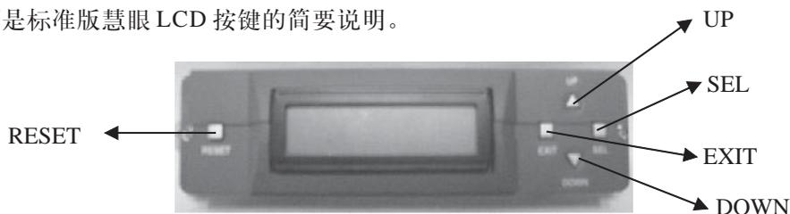
**RESET:** 该键用于复位标准版慧眼中的单片机。在菜单显示或屏幕保护状态下,按下 RESET 键,即可显示“INITIALIZING...”,此时系统日志被清空。
