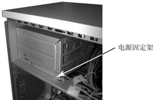
图 2-4 电源固定架安装图
