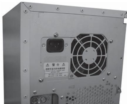
图 2-5 电源安装图
