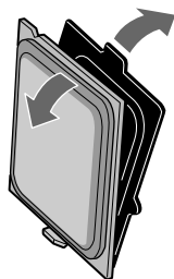
图15 取下CPU保护盖
