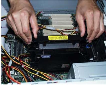
图 3.8 拆匹配板
