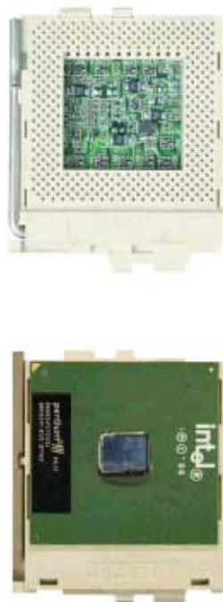
图 3-4 FCPGA 插槽：空的与安装了处理器后的
