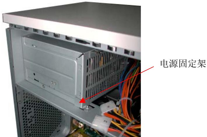
图 2-5: 电源固定架安装图
