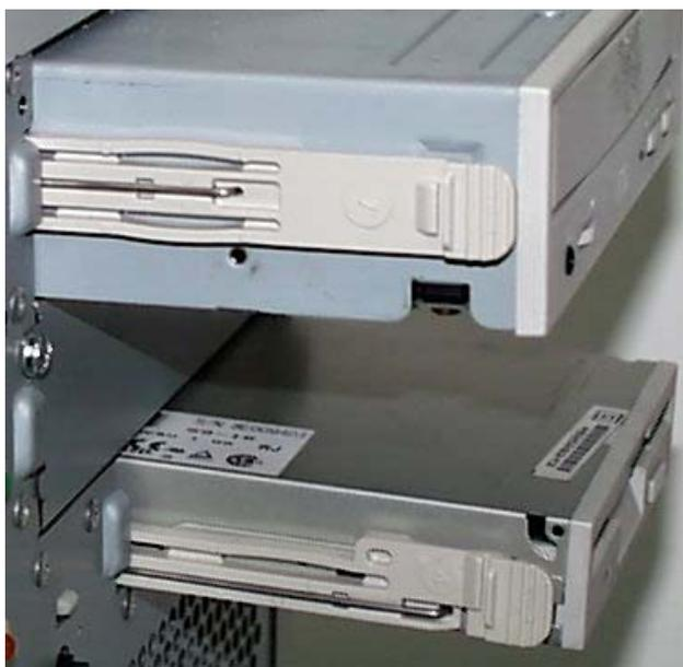
图 2-4：光驱、软驱安装图
