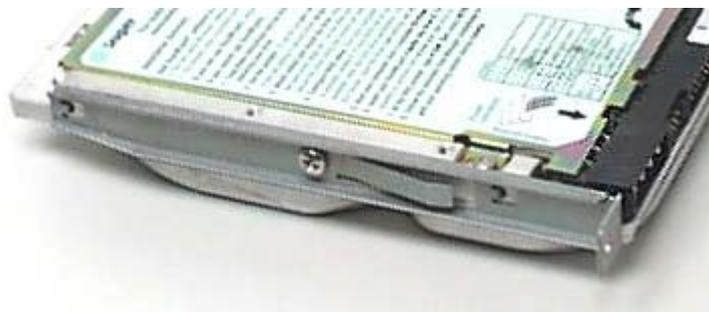
图 2-8: 硬盘导轨安装图
