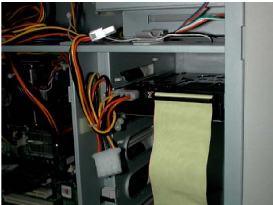
图 4-4: 硬盘的数据线和电源线
