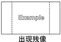
出现残像 | 切勿让静止画面显示过长的一段时间，否则该等离子面板上会留下永久的残像。静止画面包括标志、视频游戏、电脑图象、可视数据和以4:3模式显示的图像。<br><b>说明：</b><br>因使用静止图像而致使该等离子面板上留下永久性残像属于操作不当，这种情况并不会列在品质保修范围以内。<br>本产品不适用长时间显示静止图像。 |
