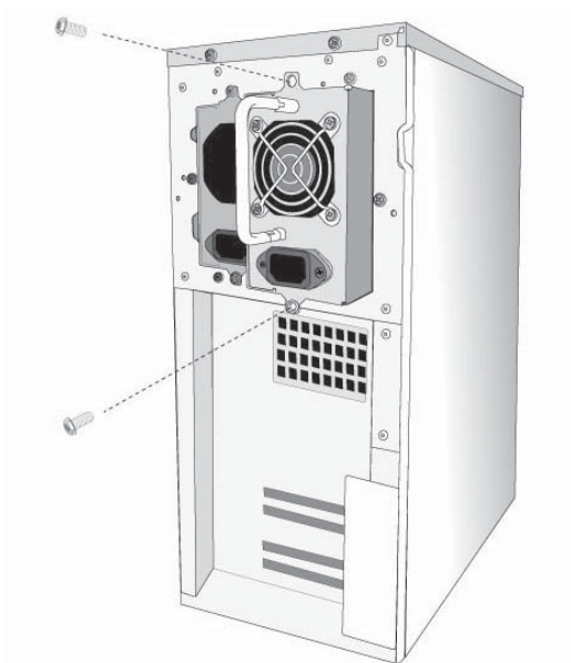
图 2-14 1+1 冗余电源的拆装
