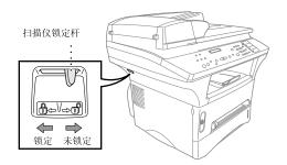
❶ 如果LCD上显示出CHECK SCAN LOCK(检 查扫描仪锁定)的消息,请确认扫描仪锁定杆 处于解锁位置,然后按停止/退出键。
