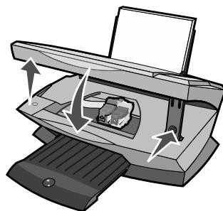
**注意：**扫描仪部分必须完全关闭，然后才可以开始新的扫描、打印、复印、或传真作业。
