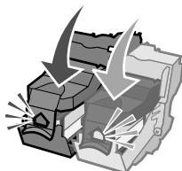
**4** 抬起掃描器組件，然後在放下掃描器組件時，將掃描器托架推回，直到組件完全關閉為止。
