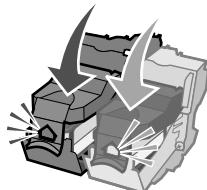
**4** 抬起扫描仪部分，向后推扫描仪支架，然后放下扫描仪部分，直到完全关闭。
