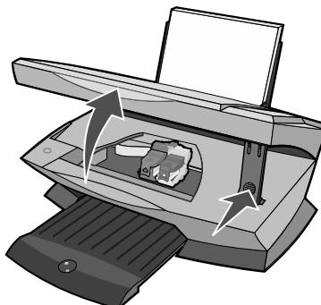
如果多功能一体机没有工作，打印墨盒拖车将会自动移动并停止在安装位置。
