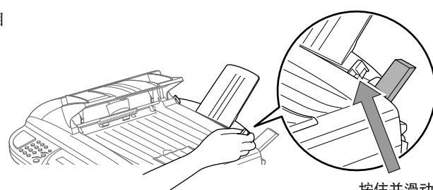
C. 按下纸张调整杆。当按下调整杆时装入纸张。确认打印面朝下，并确认纸张调整杆位于纸张标记线之下。本多功能一体机的进纸器可盛放至多200张普通纸，或至多10个信封。
