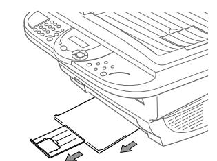
C. 如果为A4或Letter大小的纸张，请朝图示的方向拉出挡纸板。
