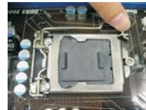
步骤 1-2. 拉起承载杠杆至完全打开到大约 135 度角的位置。
