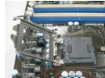
步骤 2. 去除即插即用防护罩（拾起和放置防护罩）。
