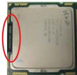
步骤 3-2. 将有 IHS（Integrated Heat Sink，集成散热片）的一面朝上。找到第 1 针和两个方向标志的凹口。
