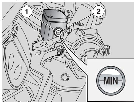
Los depósitos de líquido de frenos se encuentran ubicados en el manillar, cerca de las tomas de sujeción de las levas de freno.
