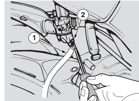
Para vaciar completamente el carburador:
