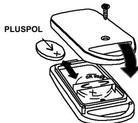
Zum Austauschen muss eine Lithium-Batterie Modell CR 2032 3V (CODE 222120050) verwendet werden.
