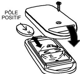
Pour le remplacement, veuillez utiliser des piles au Lithium modèle CR 2032 3V (CODE 222120050).
