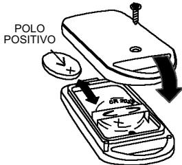
Nel caso di sostituzione si raccomanda l'utilizzo di batterie al Litio modello CR 2032 3V (COD. 222120050).
