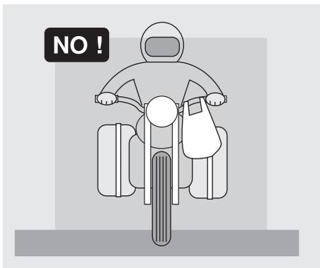
Não fixar, de nenhuma forma, objectos que estorvem, volumosos, pesados e/ou perigosos sobre guidador, guarda-lamas, e forquetas: isto pode causar uma resposta mais lenta do veículo em caso de curvas, e vai comprometer inevitavelmente a maneabilidade do veículo.
