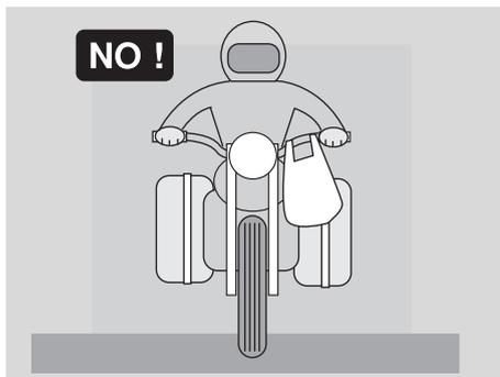
Non fissare, assolutamente, oggetti ingombranti, voluminosi, pesanti e/o pericolosi a manubrio, parafranghi e forcelle: ciò comporterebbe una risposta del veicolo più lenta in caso di curve, e comprometterebbe inevitabilmente la maneggevolezza dello stesso.
