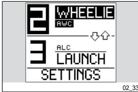
このモードを使うとライダー自身が AWC（アプリリア・ウィーリーコントロール）レベルおよび ALC（アプリリア・ラUNCHコントロール）レベルの設定/起動を行うことができます（停車状態で）
