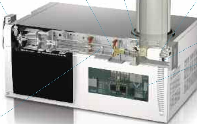
Los iones se aceleran en la celda de colisión hexapolar para **agilizar la generación de espectros de MS/MS de alta calidad.**
